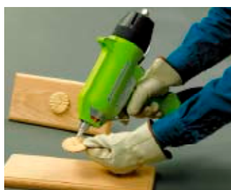
Incollaggio di elementi decorativi in legno o plastica su cassetti in legno senza prefissaggi o tempi di asciugatura.
