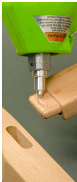
Incollaggio rapido e permanente di legno in assemblaggi ad incastro; giunti angolari in plastica o legno e bordature su pannelli (MDF).
