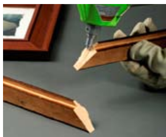
Assemblaggio di giunti a angolo con un incollaggio solido e flessibile di lunga durata.
