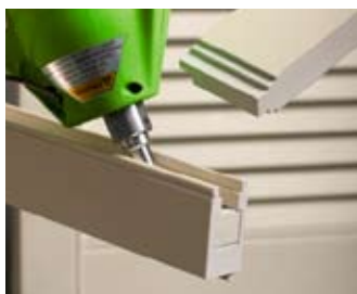
Incollaggio e sigillatura di montanti e binari di persiane per finestre.
